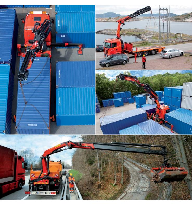
"HPSC" ofrece al operador de la grúa un grado máximo de confort y seguridad incluso cuando use la grúa en sitios con espacio limitado. A menudo sólo puede apoyarse el vehículo por un lado, parcialmente o nada en absoluto en zonas muy urbanizadas, donde haya tráfico muy intenso o en situaciones similares.
