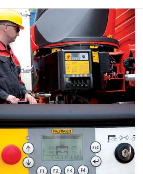
El sistema HPSC calcula el alcance útil admisible para cualquier ángulo de giro del sistema de brazos y para cualquier condición de apoyo. El sistema basado en un inteligente algoritmo de cálculo desarrollado por PALFINGER trabaja con más eficacia que los otros sistemas similares disponibles en el mercado.
