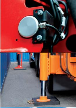
Los apoyos adicionales están también equipados con sensores odométricos e integrados en el sistema HPSC. Así se logra un sistema global eficiente.
